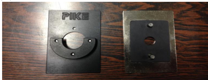
Figura 4 Direita: suporte de pastilha de 7 mm gerada por pastilhador de prensa manual. Esquerda: suporte de pastilha de 13 mm gerada por pastilhador de prensa hidráulica.
