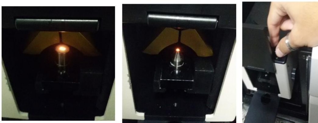
Figura 17 Centralização do feixe nos porta amostras (esquerda e centro) com o auxílio do micrômetro (direita)
