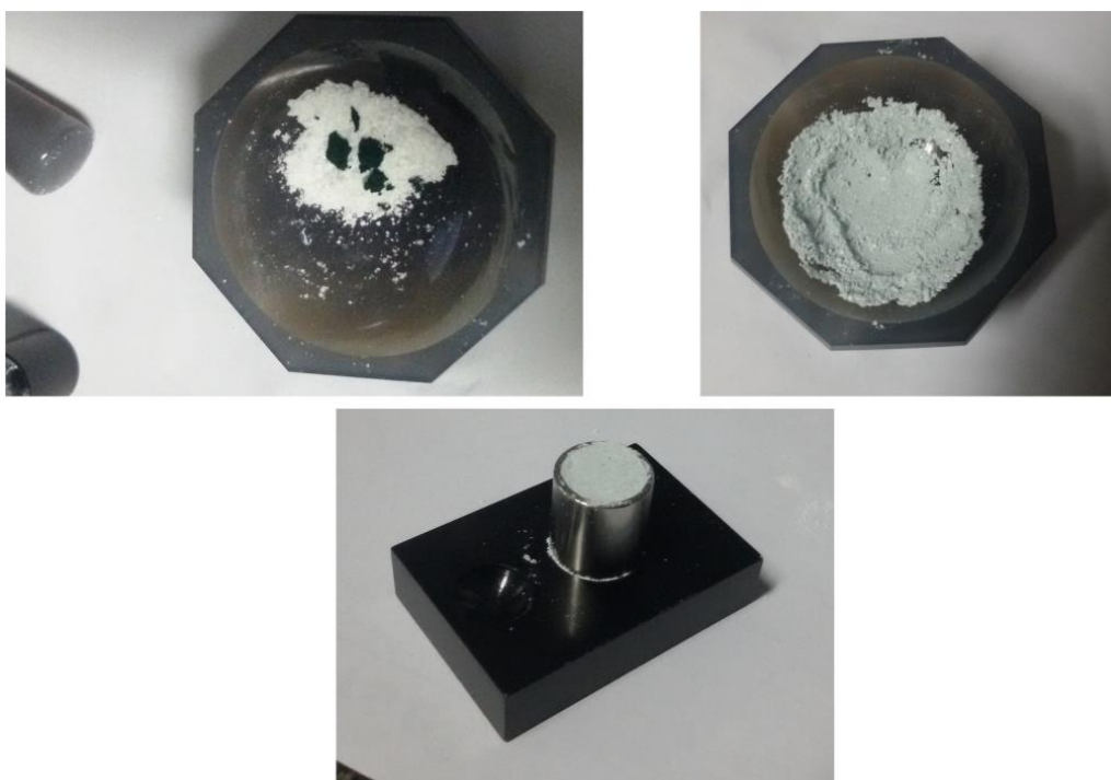
Figura 9 Preparo de amostra para análise em porta amostra grande. Procedimento análogo pode ser feito com o porta amostra pequeno.
