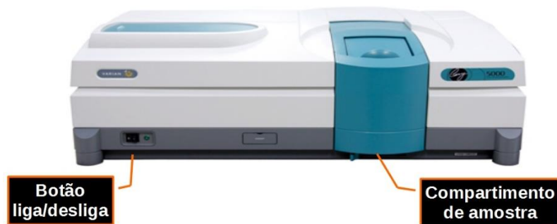
Figura 2 Cary 5000 com destaque dos principais componentes.
