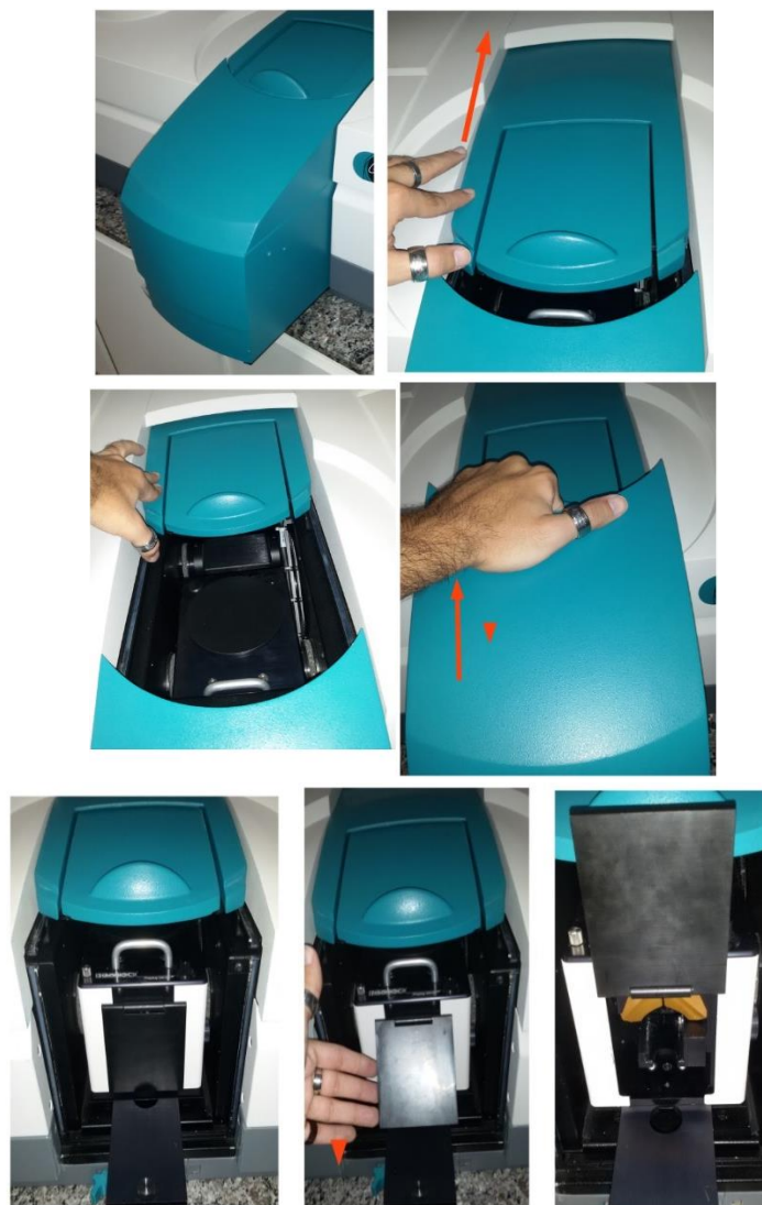
Figura 3 Cary 5000 com compartimento de amostra aberto e o acessório Praying Mantis instalado. As setas de cor laranja indicam o movimento realizado pela mão do usuário.
