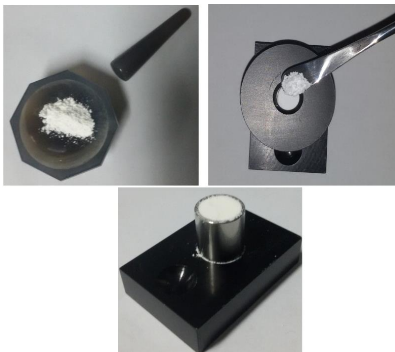
Figura 7 Preparo do material de referência no porta amostra grande.
