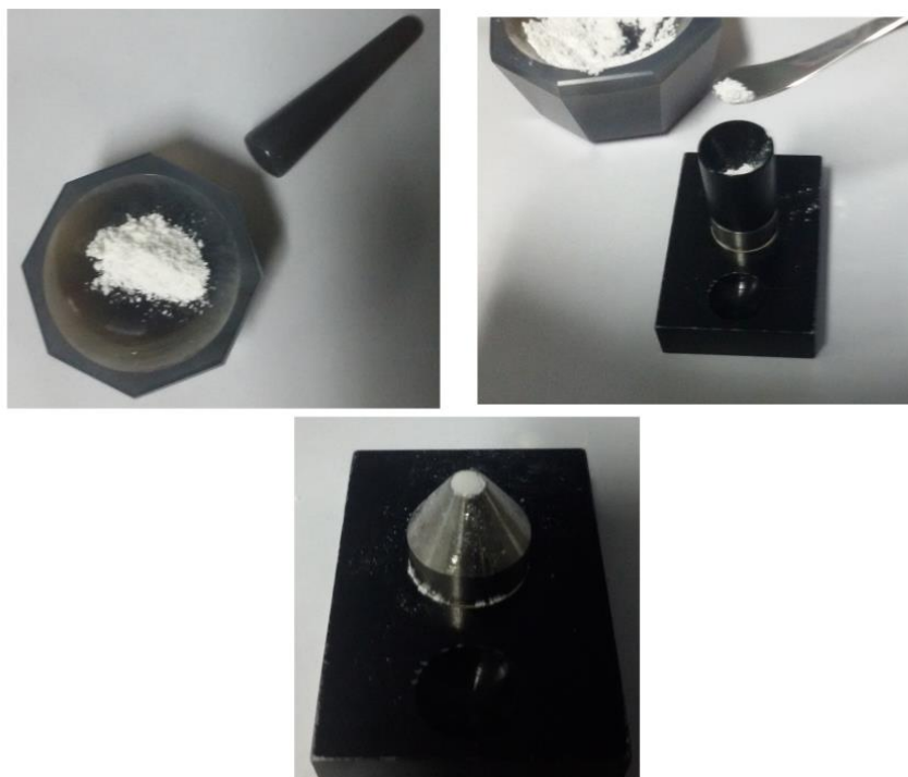
Figura 8 Preparo do material de referência no porta amostra pequeno.
